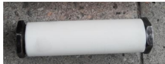
شکل (۴) پوسته پلی‌آمیدی نگه‌دارنده برس ساینده و مارپیچ
