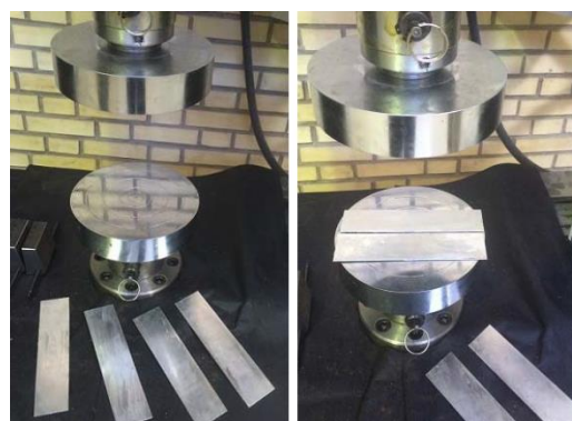
شکل (۲) چگونگی نصب تکیه‌گاه‌ها
