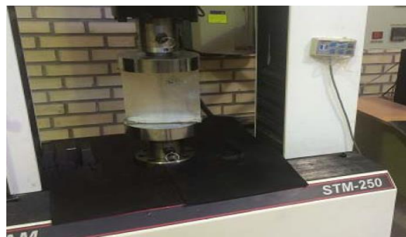
شکل (۷) اعمال بار محوری توسط دستگاه به ورق ترک دار
