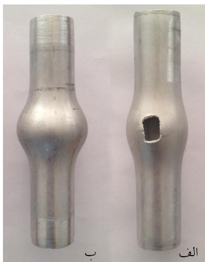
شکل (۱۰): لوله های شکل دهی شده با اعمال فشار ضربانی الف) بدون اعمال تغذیه محوری، ب) با تغذیه محوری
