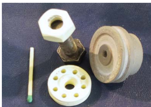
شکل (۱۰): برخی از قطعات ماشین کاری شده ترکیبات TiO_2 و Cr_2O_3 .
