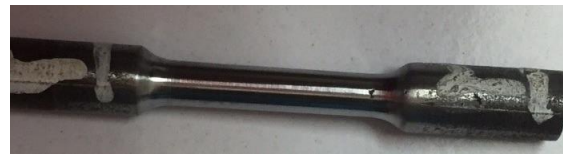
شکل (۳): تصویر نمونه کوچک شده آزمون کشش بنابر استاندارد
