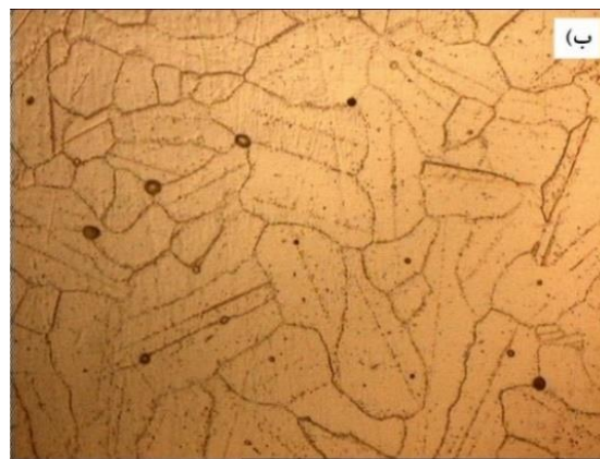
شکل (۱): ریزساختار آلیاژ نیکاز تیتانیوم آلومیناید و الف) پس از ریخته‌گری، ب) پس از همگن‌سازی.
