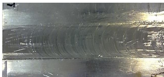
شکل (۵): جوشکاری اصطکاکی- اغتشاشی آلیاژ آلومینیوم ۵۷۵۴ به ۶۰۶۳
