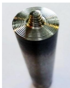
شکل (۳): شماتیک و ابعاد ابزار طراحی شده جهت جوشکاری اصطکاکی اغتشاشی
