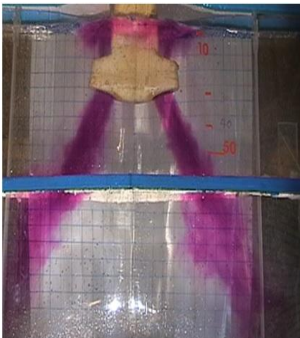
شکل (۲): مقایسه و صحت گذاری نتایج حاصل از مدل سازی ریاضی با مدل فیزیکی (گردش آب در قالب)
