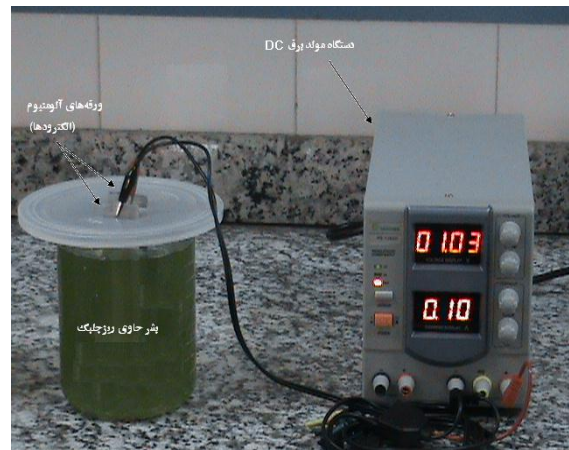
شکل ۱: تغلیظ ریزجلبک نانوکلروپسیس با استفاده از روش الکتروفلوکولاسیون
