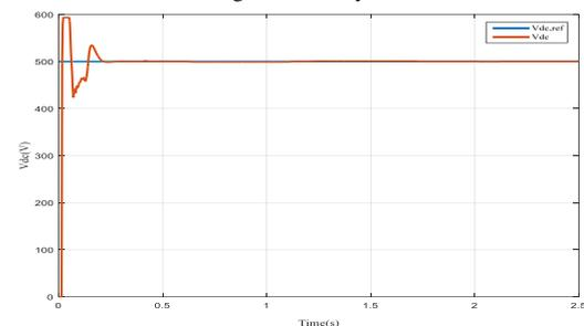
Fig. 22. Link dc voltage
