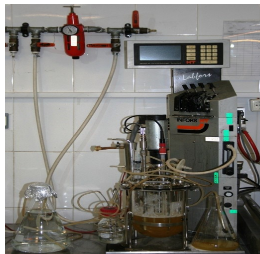
شکل ۱: بیوراکتور مورد استفاده در این تحقیق به منظور سولفورزدایی از فاضلاب.
