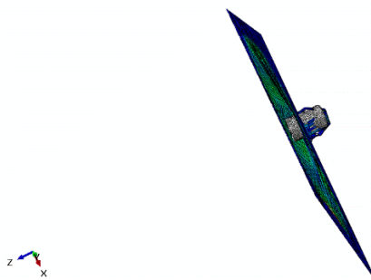
شکل ۲- شماتیک برخورد ضربه زننده به ورق شیشه/اپوکسی
