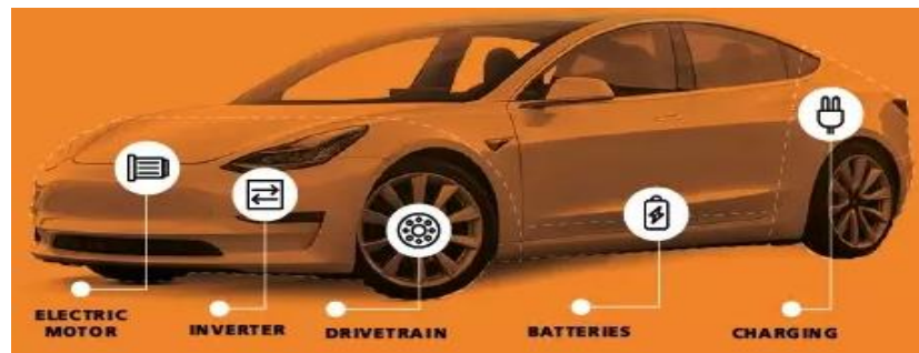
شکل ۴. طرح کلی یک خودروی برقی با اجزا اصلی آن
