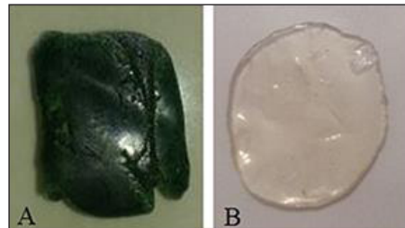
شکل ۹ پلی‌وینیل استات سنتز شده در لوله آزمایش و استفاده از همزن مغناطیسی (A) در ستون پر شده آلومینا با آرایش لایه‌ای (B)
