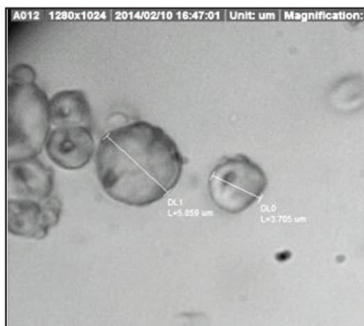
شکل ۳ تصویر میکروسکوپ نوری میکروکپسول تهیه‌شده (HD@MF)
