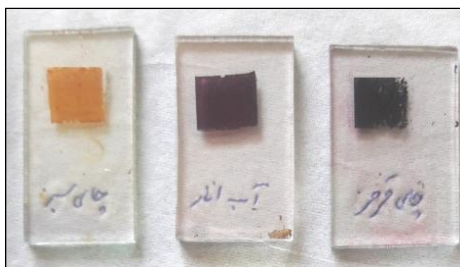
شکل ۱ الکترودهای آند پس از لایه‌نشانی \text{TiO}_2 و جذب رنگدانه روی آن.
