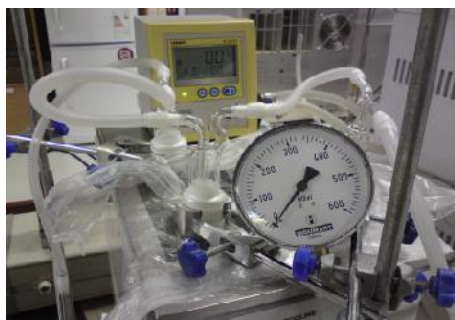
شکل 3 شمای نحوه اتصال با رابط های سیلیکونی
