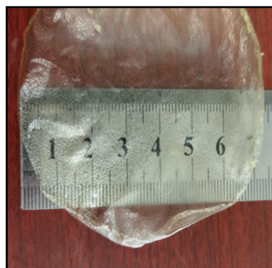
شکل ۱ فیلم نازک تهیه‌شده از کربوکسی‌متیل سلولز حاوی اسانس نعنا و روغن زیتون
