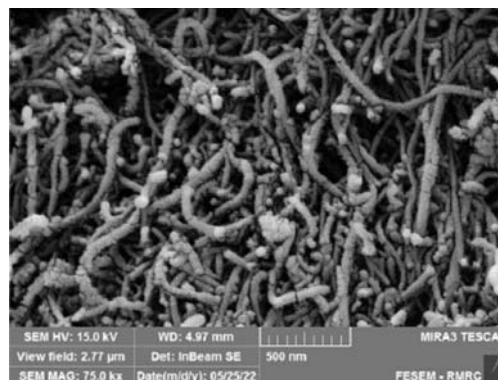
شکل ۳ تصویر SEM نانوجندسازه مغناطیسی Cu/Fe 3 O 4 @MWCNTs
