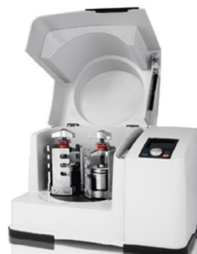
شکل ۱ تصویر دستگاه آسیاب گلوله‌ای سیاره‌ای
