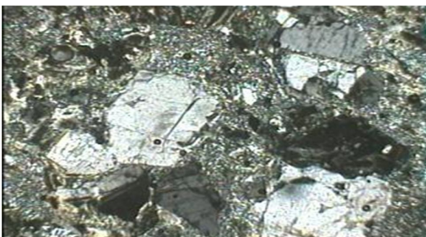
تصویر ۱۲- میکروکلین به همراه کوارتز در یک گرانیت (XPL).
