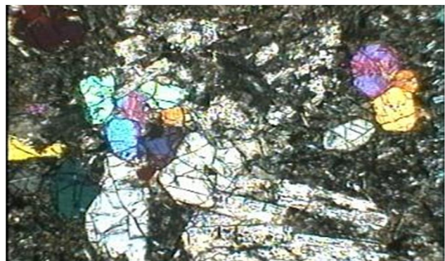
تصویر ۸- بافت گلمروپرفیریک در یک الیون بازالت با کانی‌های الیون (سمت راست تصویر) بدون آلتراسیون (XPL)
