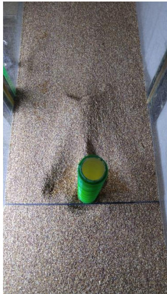
شکل ۳- شکل حفره آبستگي در مجاورت آبپایه و با کابل بدون آبپایه
