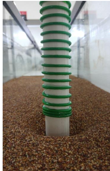
شکل ۳- شکل حفره آبستگي در مجاورت آبپایه و با کابل بدون آبپایه
