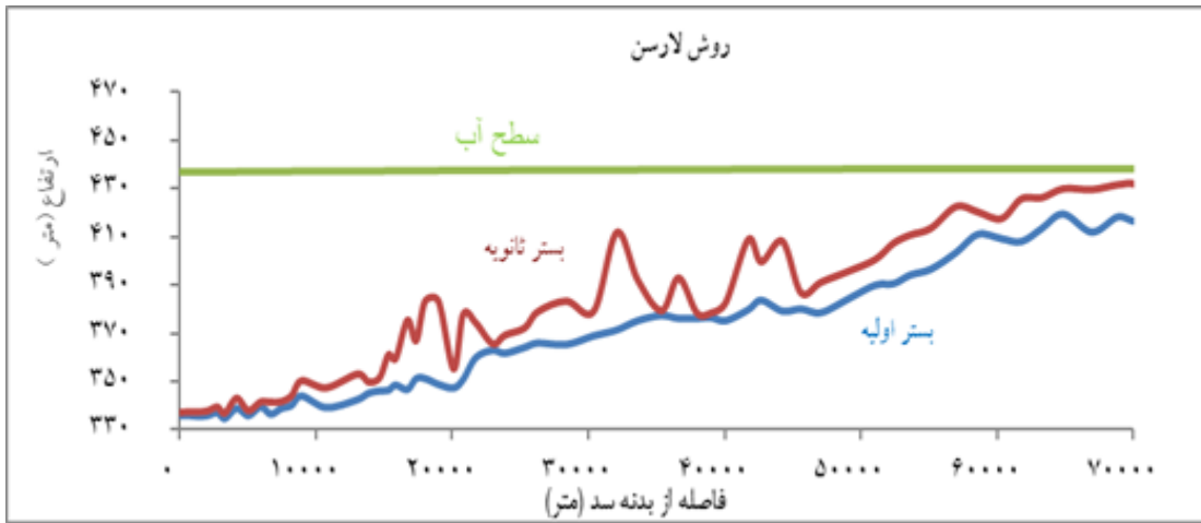
شکل (۶) - منحنی تراز حجم پس رسوب بمیزان ۱۳۹۶۰۰۰۰۰ تن با استفاده از معادله میر - پیتر و مولر
