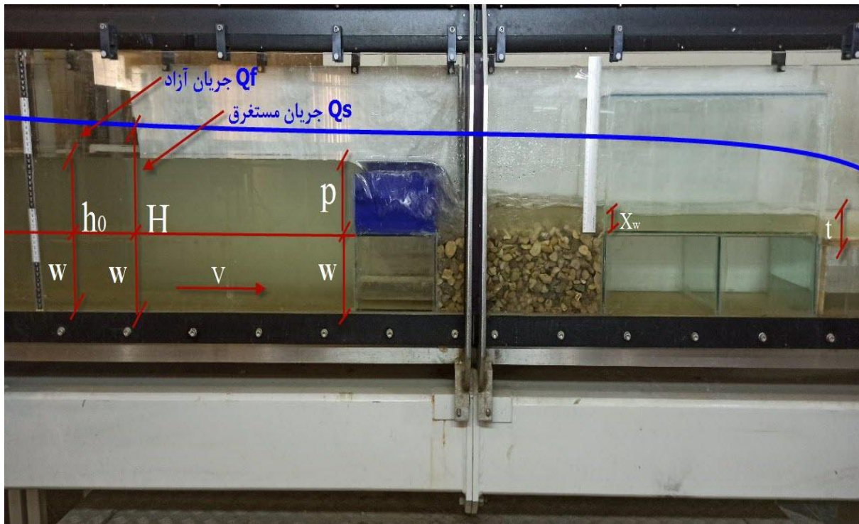
شکل ۱- محل قرارگیری سرریز درون فلوم آز مایشگاهی و پارامترهای اندازه گیری شده
