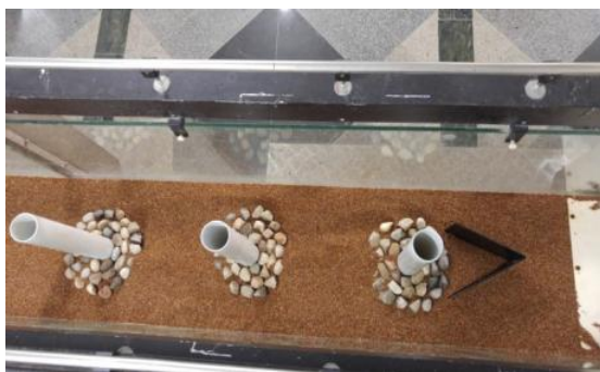
شکل ۱۱- تصویر گروه پایه با حضور سنگ چین و نصب یک صفحه مستغرق بعد از آبشستگی
