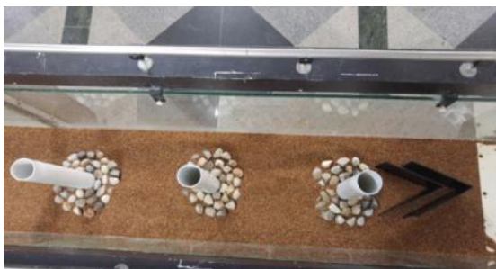
شکل ۱۸- تصویر گروه پایه ها با حضور سنگ چین و نصب در صفحه مستغرق قبل از آبشستگی
