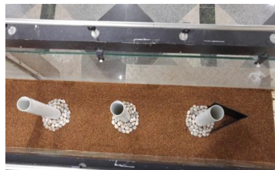
شکل ۱۰- تصویر گروه پایه با حضور سنگ چین و نصب یک صفحه مستغرق قبل از آبشستگی
