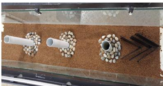
شکل ۲۶- تصویر گروه پایه ها با حضور سنگ چین و نصب دو صفحه سه صفحه مستغرق بعد از آبشستگی نتیجه گیری
