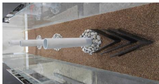
شکل ۲۷- تصویر گروه پایه ها با حضور سنگ چین و نصب سه صفحه مستغرق قبل از آبشستگی
