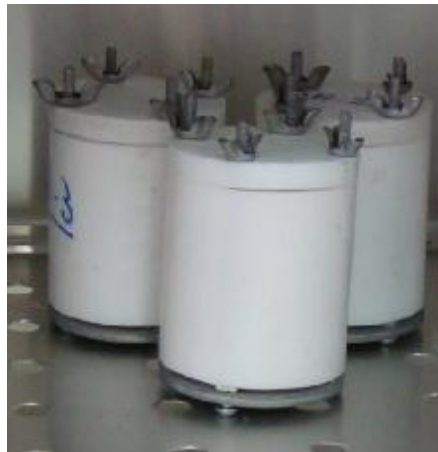
شکل ۱- ظروف تفلونی سنتز سیلیکا آئروژل
