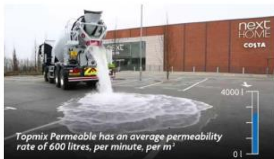
شکل ۳۰. تست نفوذپذیری بتن خود زهکشی [۱].
