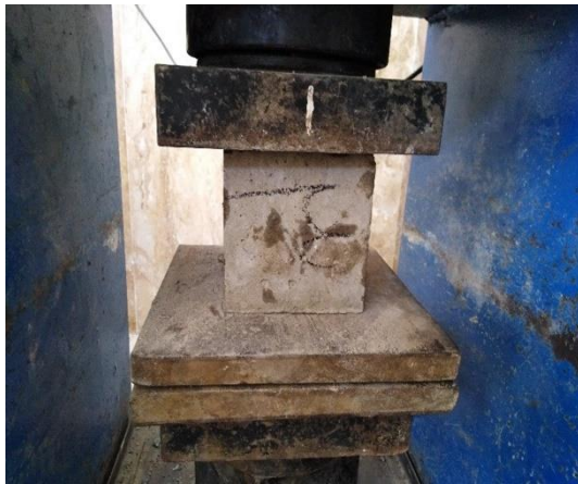
شکل ۳- نمونه بتنی در حال انجام آزمون مقاومت فشاری
