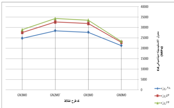
شکل ۵- نمودار مدول الاستیسیته دینامیکی نمونه‌های گروت حاوی نانوسیلیس
