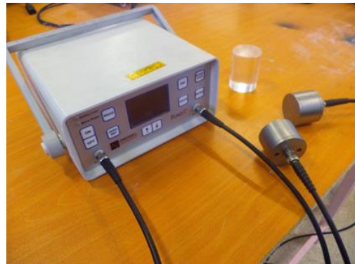
شکل ۲- دستگاه مبدل سرعت پالس اولتراسونیک مورد استفاده در این پژوهش
