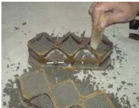
شکل ۱- قالب گیری نمونه های آزمایشگاهی گروت
