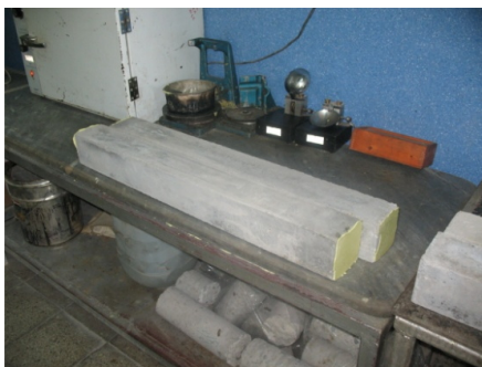
شکل ۱۶- کپینگ کردن نمونه‌ها توسط گوگرد
