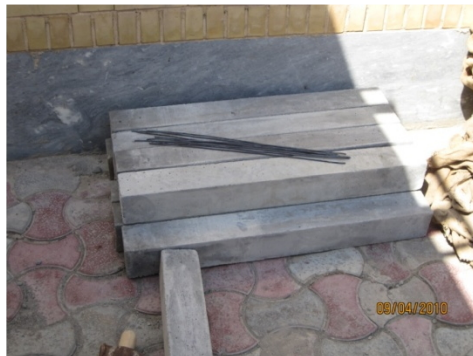
شکل ۱۰- ستون‌های اولیه آزمایشگاهی قبل از مقاوم‌سازی
