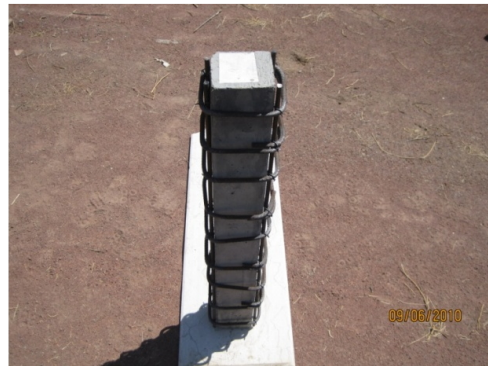
شکل ۱۲- تصویر مربوط به اتمام غلاف‌بندی
