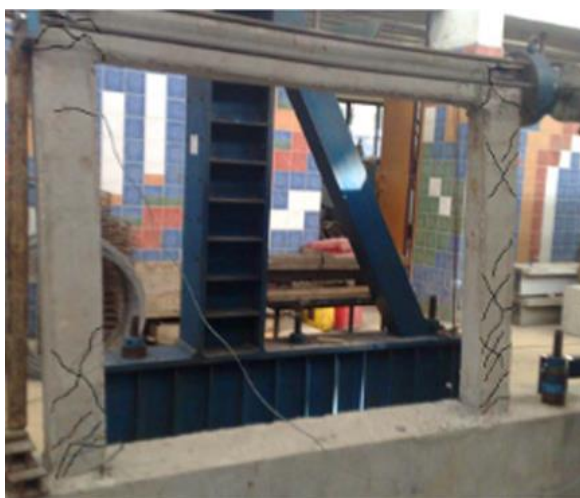
شکل ۹- ترک خوردگی در نمونه F1 حاصل از مطالعه آزمایشگاهی [۱۱]
