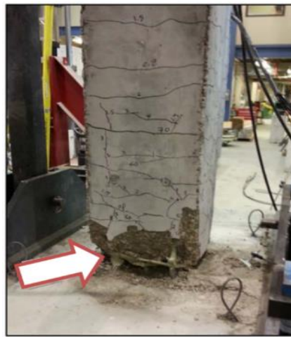
شکل الف) نوع شکست مفصلی ستون در آزمایشگاه [۷]
