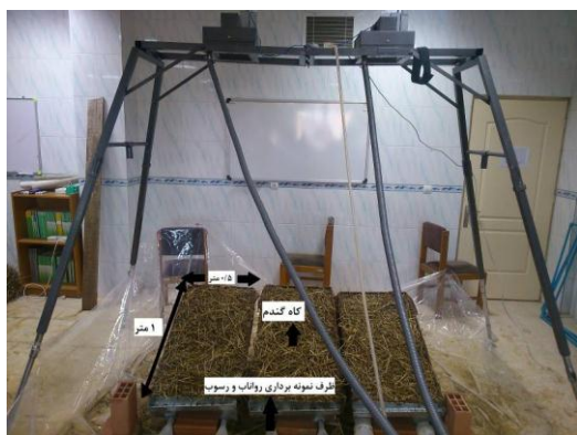
شکل ۱. کرت‌های آزمایشگاهی، دستگاه شبیه ساز باران و حفاظت خاک با استفاده از بقایای گندم
