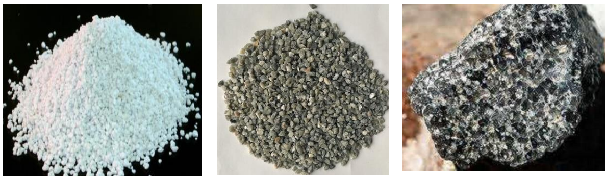
شکل ۳. انواع مختلف پرلیت سنگ پرلیت (الف)، سنگ پرلیت خرد شده (وسط) و پرلیت منبسط شده (ج)
