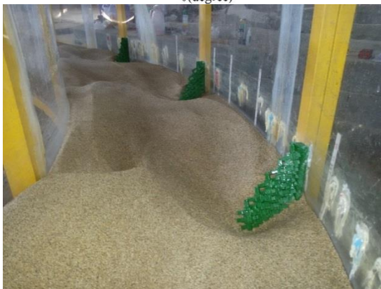
شکل ۶. تغییرات عمق فرسایش در سه مسیر دیواره‌های داخلی و خارجی و دماغه آب‌شکن با طول مؤثر ۱۵ سانتیمتر
