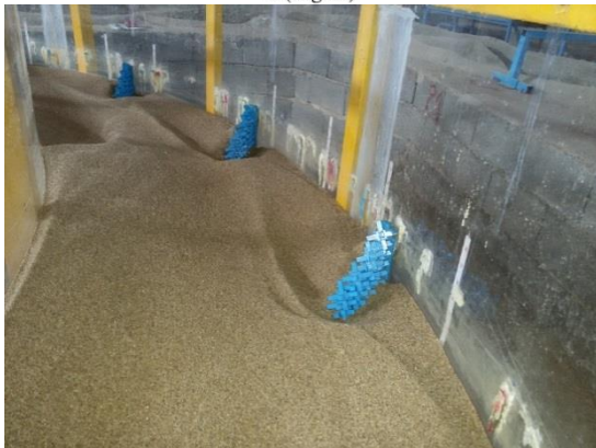
شکل ۵. تغییرات عمق فرسایش در سه مسیر دیواره‌های داخلی و خارجی و دماغه آب‌شکن با طول مؤثر ۱۲ سانتیمتر
