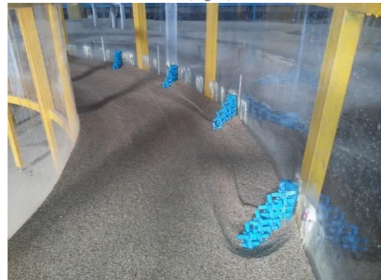
شکل ۵. تغییرات عمق فرسایش در سه مسیر دیواره‌های داخلی و خارجی و دماغه آب‌شکن با طول مؤثر ۱۲ سانتیمتر
