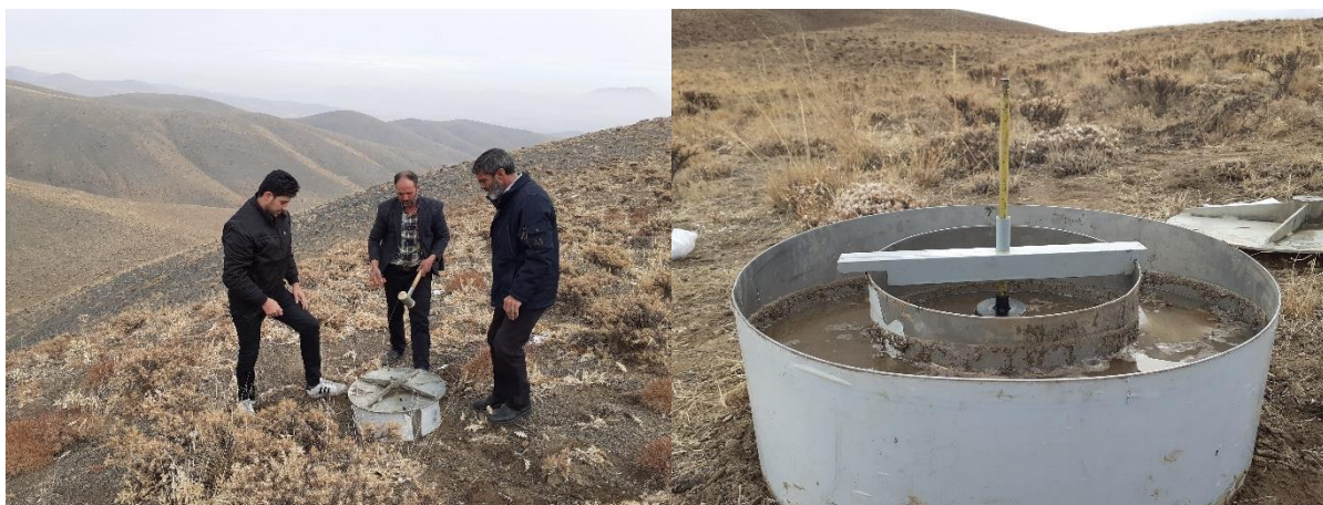
شکل ۲. اندازه‌گیری میدانی نفوذپذیری به روش استوانه مضاعف
