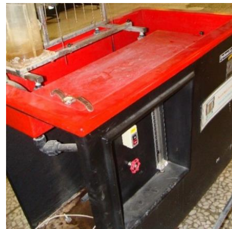
شکل ۲. دستگاه اندازه‌گیری دبی حجمی
