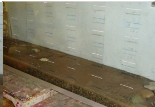
شکل ۶. افزایش دبی جهت رسیدن به آستانه حرکت
