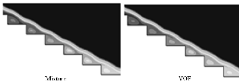
شکل 6. الگوی جریان آب و هوای تشکیل شده برای بده واحد عرض 0/103 \text{ m}^2/\text{s} .
