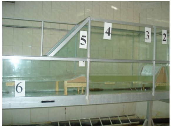
شکل ۱۰- نحوه‌ی قرار گرفتن سرریز سطحی و سطحی تنظیم کننده در نهر پایه دار و مقاطع اندازه‌گیری داده‌ها
