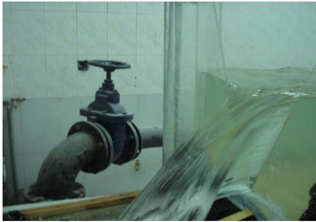
شکل ۹- سرریز مثلثی ۴۵ درجه و عبور جریان از روی آن
