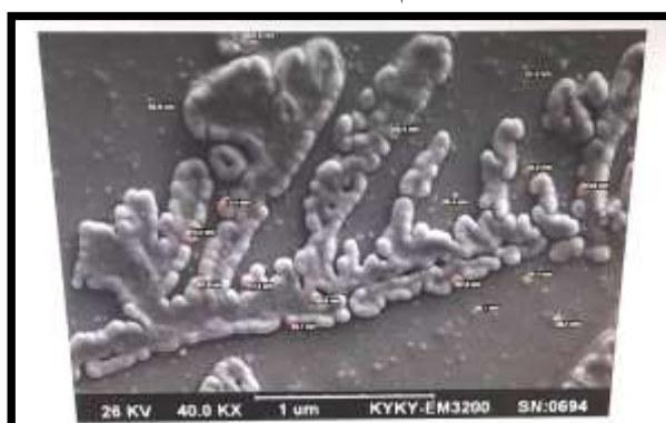
شکل ۳. تصویر میکروسکوپ الکترونی (SEM) روبشی نانو ذرات نقره سنتز شده.
