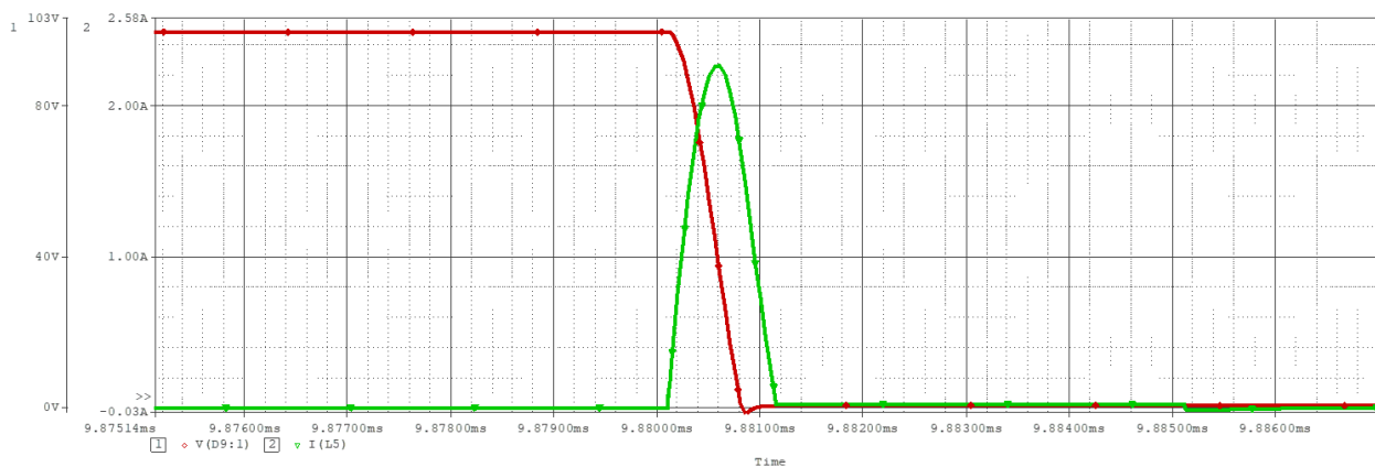
شکل (۱۱): شکل موج‌های ولتاژ خازن اسنابر و جریان L_5(L_{a1})
