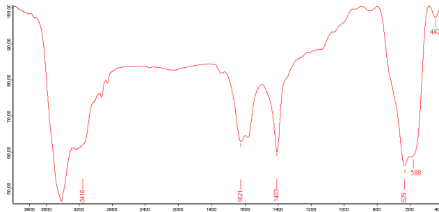
شکل ۲. طیف عبوری FTIR از نمونه سنتز شده به روش رسوبی کاهشی در R_0=3
