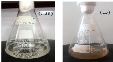
شکل ۱- تولید نانوذرات نقره (الف) قبل و (ب) بعد از تلقیح شدن سلول‌های جدایه اکتینومیست در محلول AgNO_3
