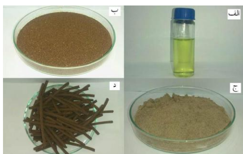
شکل ۱- روغن بذر توتون حاصل از روش پرس سرد (الف)، بذر توتون قبل از استخراج (ب)، بذر توتون بعد از روغن‌گیری به روش سوکسله (ج)، تفاله حاصل از روغن‌گیری به روش پرس سرد (د).
