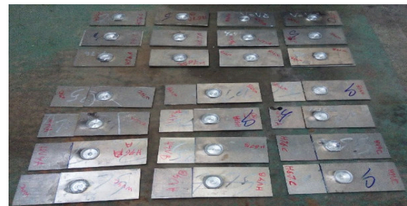
شکل ۱- چیدمان صفحات در دو حالت رویهم و همپوشانی شده
