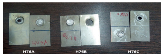
شکل ۶- حالات شکست‌های جوش در ابزار عملیات حرارتی شده در نمونه‌های H76 به ازای سرعت‌های دورانی مختلف
