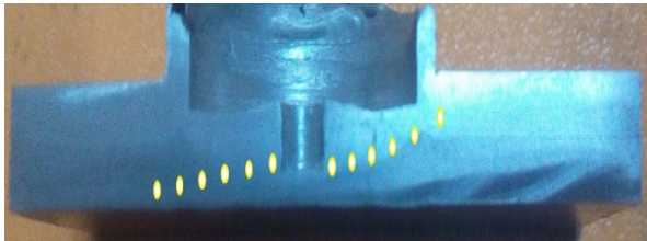
شکل ۸- پروفیل ۱۲ نقطه‌ای گرفته شده جهت انجام تست ریزسختی
