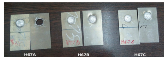
شکل ۷- حالات شکست جوش تولید شده با ابزار عملیات حرارتی شده در نمونه‌های H67 و سرعت‌های مختلف دورانی ابزار
