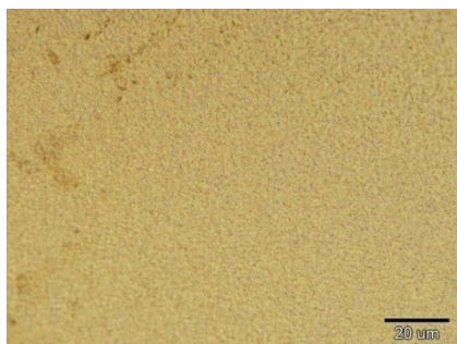
شکل ۱۲: تصویر میکروسکوپ نوری نانوذرات اکسید تیتانیوم ۲۱ نانومتری.
