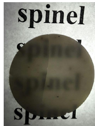
شکل ۵: تصویر نمونه دیسکی شکل سرامیک شفاف اسپینل تهیه شده با SPS.
