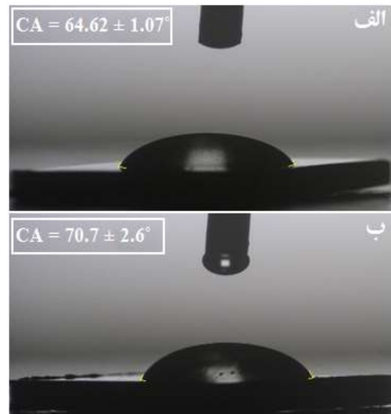
شکل (۶): تصاویر زاویه تماس: (الف) زیرلایه تیتانیومی فاقد پوشش و (ب) زیرلایه تیتانیومی دارای پوشش DLC.
