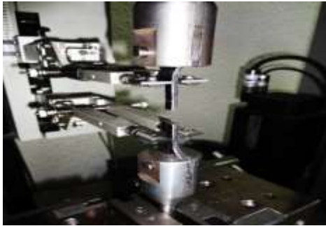
شکل (۱۲): آزمون کشش نمونه‌های حجمی.
