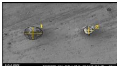
شکل (۱۰): تصویر حاصل از میکروسکوپ الکترونی روبشی از ناحیه جوش نمونه جوشکاری شده با الکتروود E6010 به همراه آنالیز عنصری از آخال نشان داده شده در تصویر.
