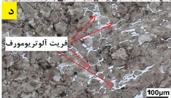
شکل (۶). تصاویر OM نمونه‌های نرمالیزه شده: الف) نمونه ساده قبل از اچ، ب) نمونه ساده بعد از اچ، ج) نمونه مرکب قبل از اچ و د) نمونه مرکب بعد از اچ.
