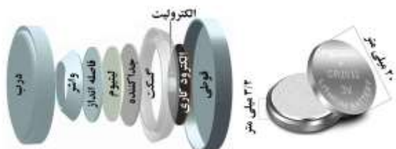
شمای (۱): اجزاء و ابعاد نیم - پیل لیتیوم از نوع ۲۰۳۲.
